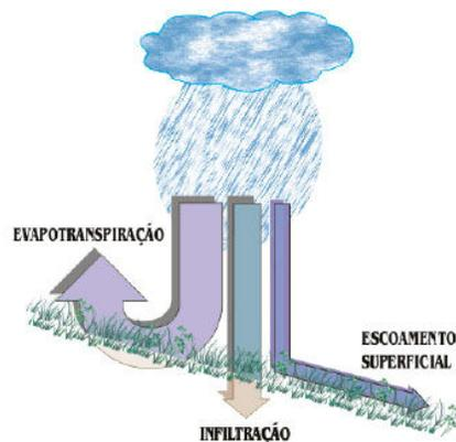
Figura 2 – Retenção da água na cobertura vegetal (Fonte: Da Cunha, 2004)
