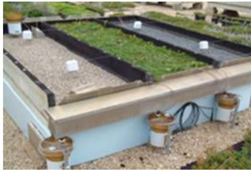
Figura 20 - Medições de escoamento para diferentes superfícies (MICHIGAN STATE UNIVERSITY, 2006)
