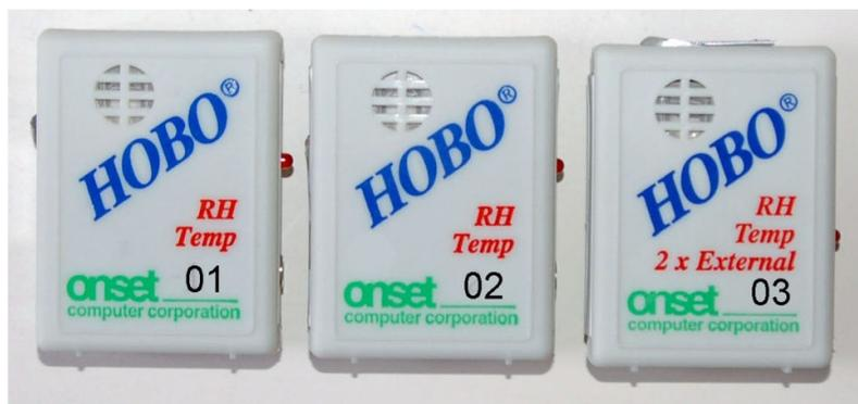
Figura 65 – Equipamentos para as medições higrotérmicas
