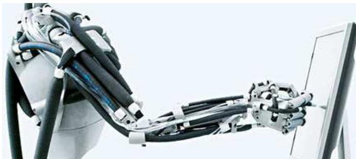
Figura 2.4 - Robô com músculos artificiais
