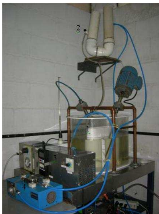
Figura 13. Instalação piloto: reator (1), tanque anóxico (2), painel de controle com vacuômetro acoplado (3) e bomba peristáltica de recirculação (4).
