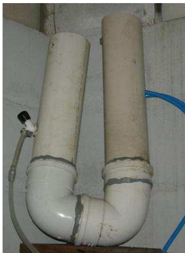
Figura 11. Tanque anóxico em forma de U confeccionado e utilizado nas instalações experimentais.
