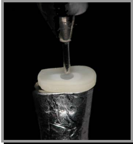
Figura 21 – Corpo de prova posicionado na máquina de teste.
