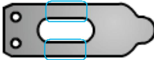
Figura 11: Locais de concentração de deformação devido à flexão
