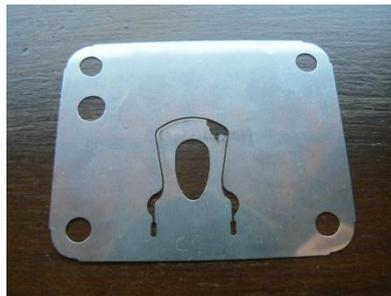
Figura 12: Exemplo de válvula danificada devido à fadiga de impacto
