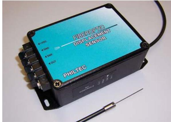
Figura 26: Condicionador de sinais e sensor do sistema de medição de fibra óptica
