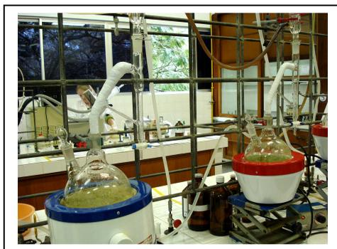
**Figura 4.1** Aparato experimental para a extração de óleo essencial de ameixa de raleio por arraste de vapor, hidrodestilação (acervo do autor, 2008).
