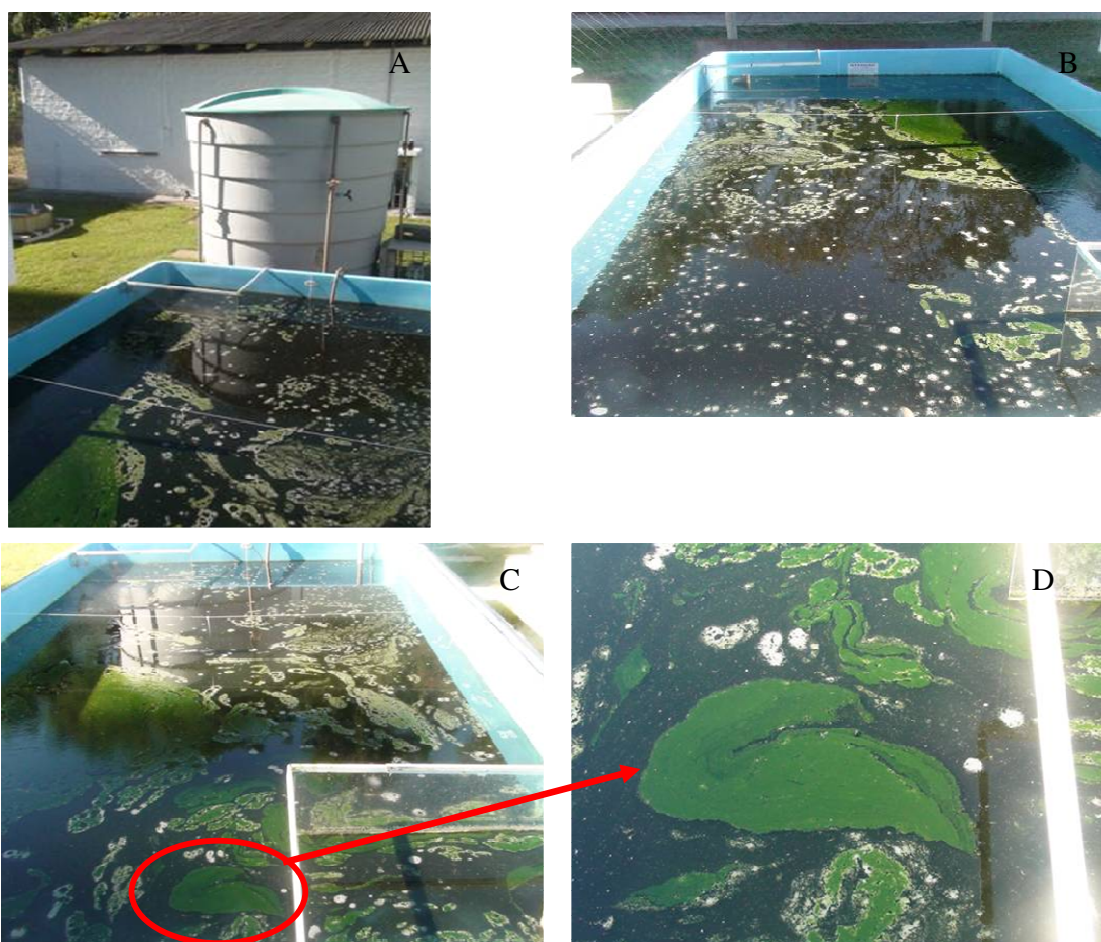
Figura 57: Floração da biomassa algal na L2 (Etapa 1). A e B) Vista superior de L2. C) Biomassa fitoplanctônica formando uma “pasta viscosa” e D) Vista em aumento, tornando visível além das biomassa algal, bolhas de oxigênio liberadas para a superfície.
