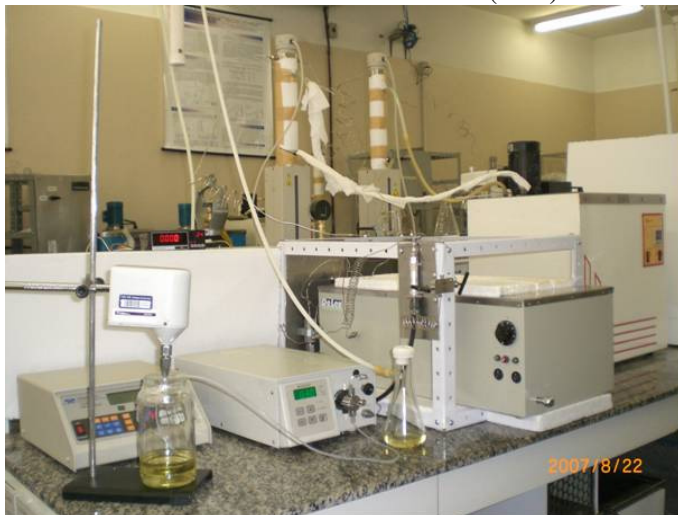
Figura 3. 5 - Vista geral do aparato experimental de produção enzimática de biodiesel em propano pressurizado em modo contínuo.
