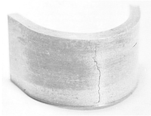
Figura 26: Falha em flexão (Dobramento) [25].
