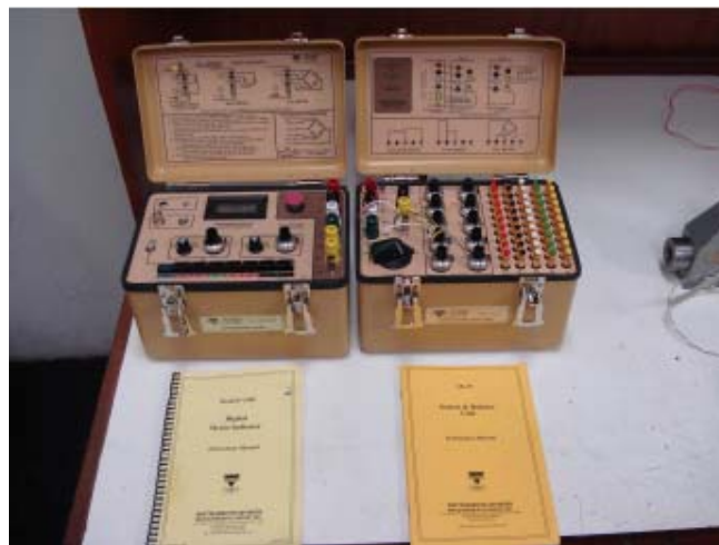
Figura 35: Conjunto Vishay P-3500 e SB-10 [Do autor].
