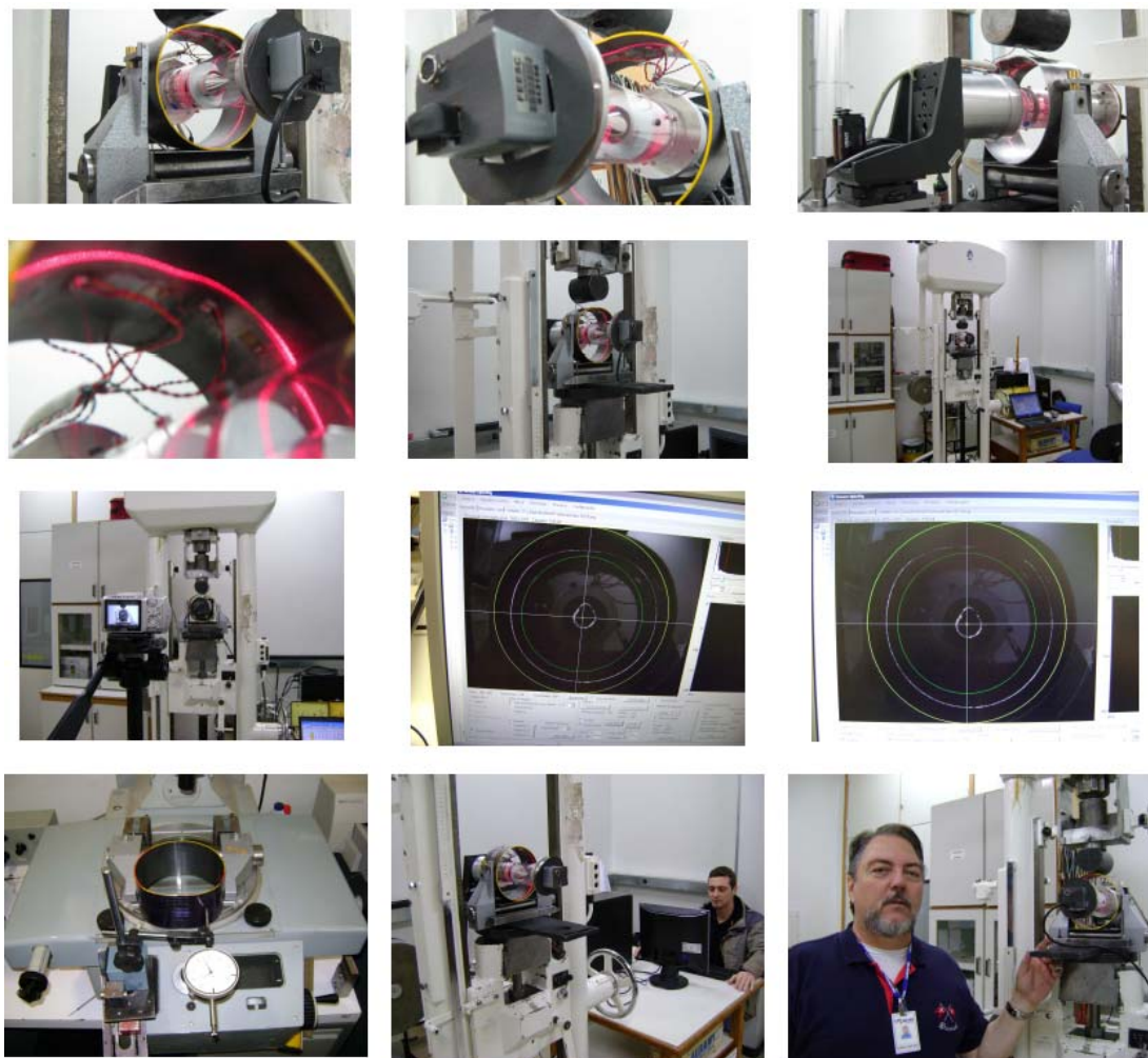
Figura 36: De cima para baixo, da esquerda para direita, CP e Sistema PEROLA usado para medir a geometria interna do CP, a máquina de tração com o indetador fixado ao carro móvel, acompanhamento fotográfico, sistema aquisitório, bancada para medição com relógio comparador e, Pedro Buschinelli e o autor [Do autor].
