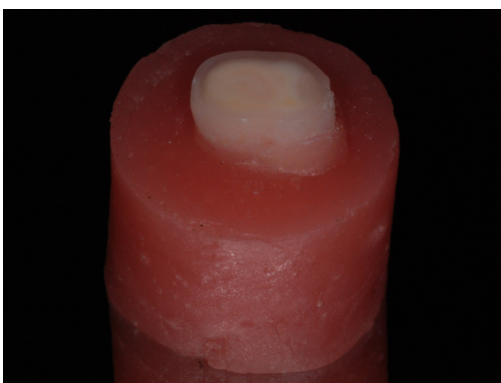
Figura 8 - Espécime após planificação da face oclusal com lixas de carbeto de silício (n os 220, 400 e 600).
