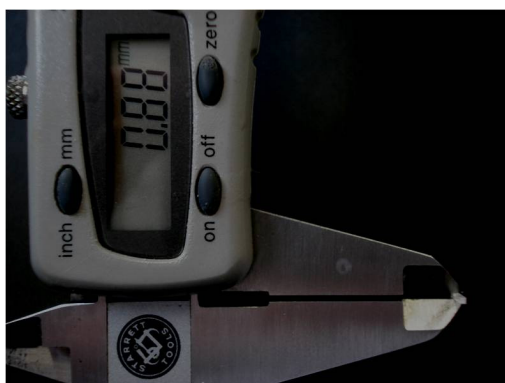
Figura 15 - Área de secção transversal do corpo-de-prova sendo aferida com paquímetro digital ( \cong 0,8 \text{ mm}^2 ).
