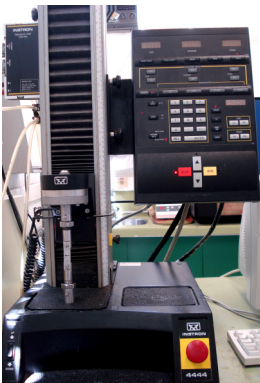
Figura 17 - Teste de microtração sendo realizado em máquina de ensaios (4444, Instron), com velocidade de 0,5 mm/min.
