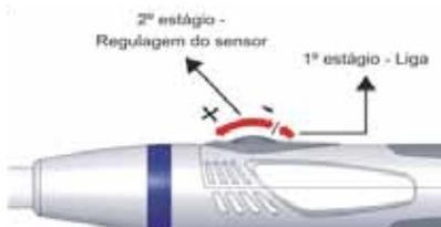
**Figura 11** – Comandos do protótipo vista lateral esquerda.
