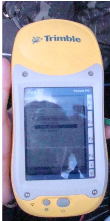
Figura 5-3 – Coleta das coordenadas com o GPS topográfico de frequência simples.
