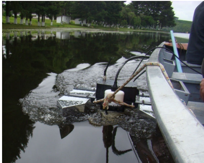
Figura 5-4 – Levantamento batimétrico no reservatório 1 utilizando o ADCP com o Catamaran.
