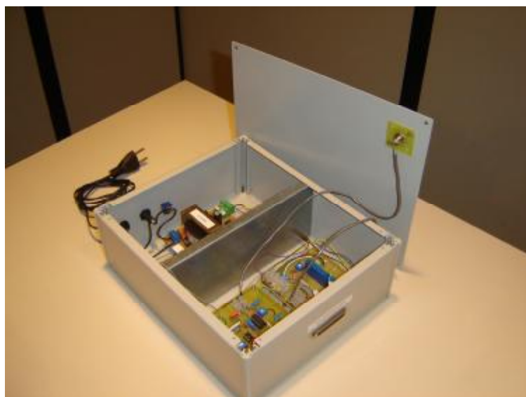
Figura 38 – Sistemas de medição de tensão (SMV) e de corrente (SMI) desenvolvidos
