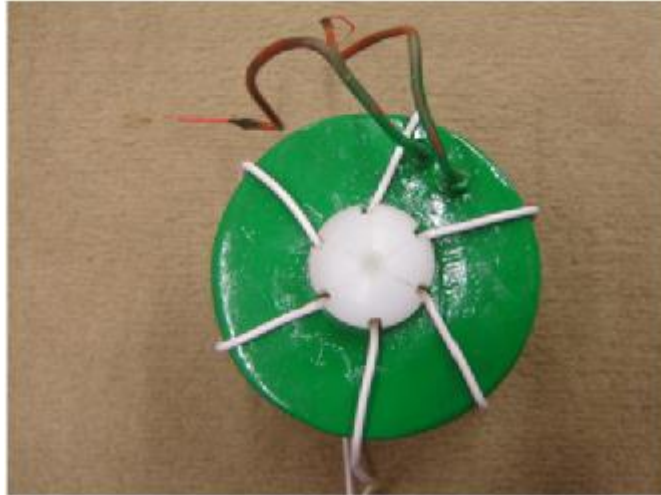
Figura 37 – Bucha de nylon utilizada para manter o condutor fixo em uma posição dentro da “janela” da bobina de Rogowski e, ao mesmo tempo, aumentar a amplitude de sua tensão de saída
