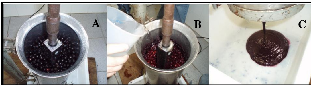
Figura 6. Produção de açaí em despulpadora elétrica vertical; frutos dentro do cilindro de aço inoxidável (A); adição de água potável durante o despulpamento (B); saída gravitacional do açaí por orifício no fundo da despulpadora elétrica (C).
