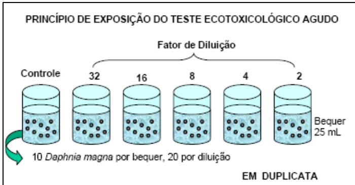
Figura 20 Esquema do teste de toxicidade aguda com Daphnia magna (Fonte: Brentano, 2006)
