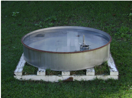
Figura 9 Evaporímetro Tanque Classe A utilizado para medir a evaporação natural ambiente
