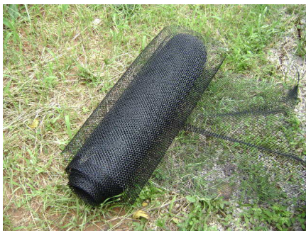
Figura 11 Tela utilizada para elevar a superfície específica do painel de evaporação
