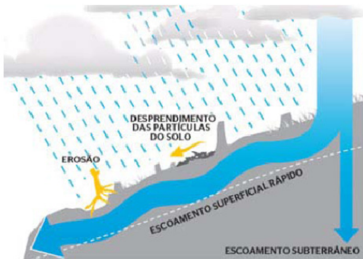
Figura 1 – Processo de decapamento acelerando escoamento superficial
