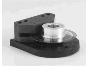
Figura 6.3: *Encoder* da fabricante USDigital utilizado no SIAMES
