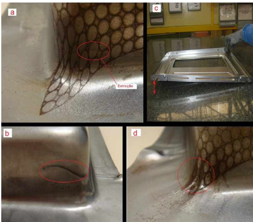
Figura 4.7 – Defeitos de estampagem analisados: (a) Estricção; (b) Fratura; (c) Distorção de forma; (d) Enrugamento
