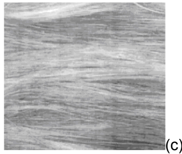
Figura 2.2. (a) Orientação das fibras de vidro curtas em Compósitos [5] (b) Componentes da fibra orientadas aleatoriamente (c) fibras orientadas unidirecionalmente [6].
