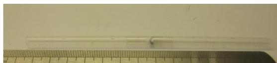
**Figura 21. Montagem da amostra para medição no SQUID.**
