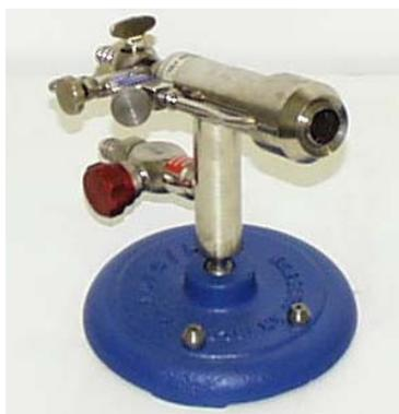
**Figura 14.** Maçarico utilizado para o selamento de ampolas de quartzo.
