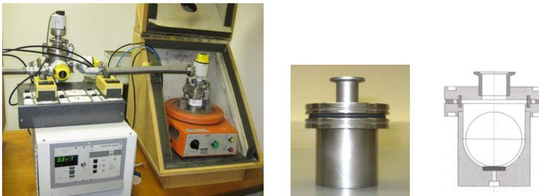
**Figura 13.** Moinho vibratório Pulverisette 0 da Fritsch e bomba de vácuo turbomolecular acoplada. Lado direito da figura, imagens do cadinho utilizado para a mecano-síntese neste moinho (Tegus, 2003).
