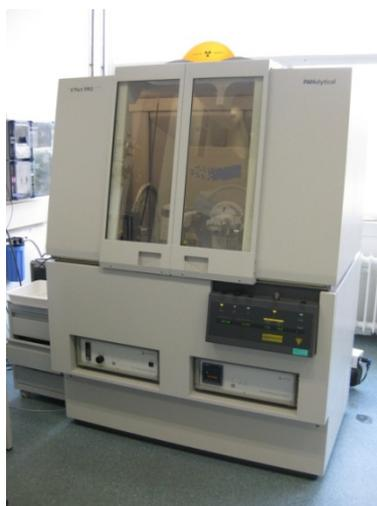
**Figura 16. Difratômetro Philips X'pert PRO na TUDelft.**
