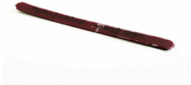
Figura 4.46 - Corpo de prova submetido a ensaio de fadiga em equipamento de DMA (temperatura de processamento de 260 °C, amplitude do deslocamento 1 mm e frequência do ensaio de 10Hz).
