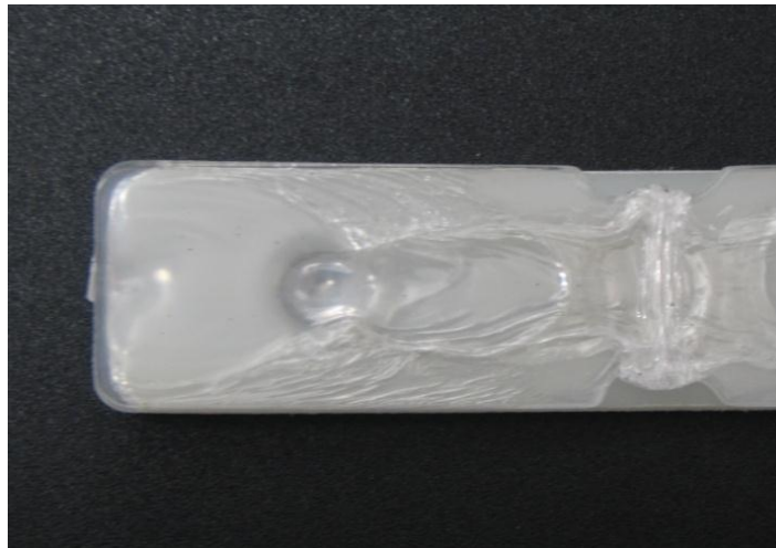
Figura 14 – Fotografia da peça sobreinjetada com PC, evidenciando o amolecimento sofrido pelo inserto de PEAD.
