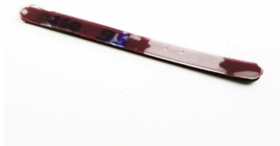
Figura 4.44 - Corpo de prova submetido à ensaio de fadiga em equipamento de DMA (temperatura de processamento de 260 °C, amplitude do deslocamento 2mm e frequência do ensaio de 10Hz).
