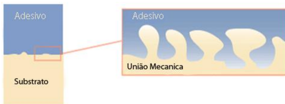
Figura 2.16 - Desenho esquemático do processo de adesão por união mecânica entre substrato (inserto) e polímero sobreinjetado (Adaptado de PACKHAM, 2005).
