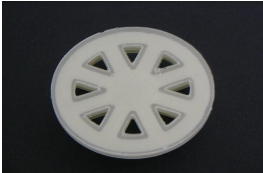
Figura 19 - Fotografia do inserto em ABS sobreinjetado com polipropileno copolímero heterofásico de propeno e eteno, evidenciando uma boa transparência da camada de recobrimento.
