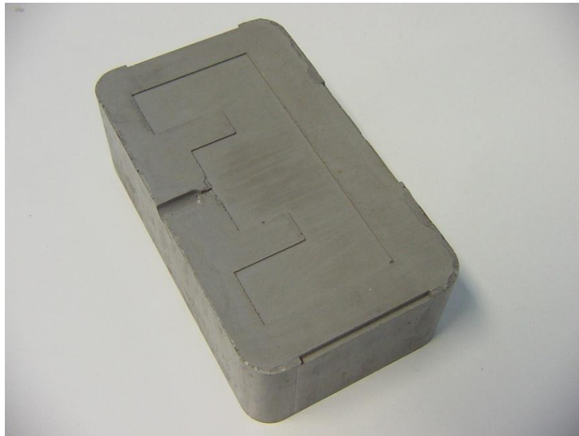
Figura 2 - Molde de paredes finas fabricado pelo processo de vazamento de resina epóxi.
