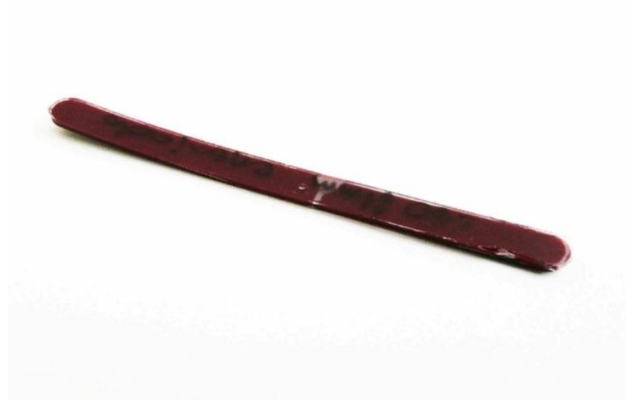
Figura 4.33 - Corpo de prova para a realização dos ensaios de flexão e fadiga em equipamento para ensaios dinâmico mecânicos.
