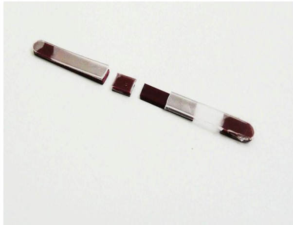
Figura 4.43 - Corpo de prova submetido à ensaio de fadiga em equipamento de DMA (temperatura de processamento de 240 °C, amplitude do deslocamento 2mm e frequência do ensaio de 10Hz).
