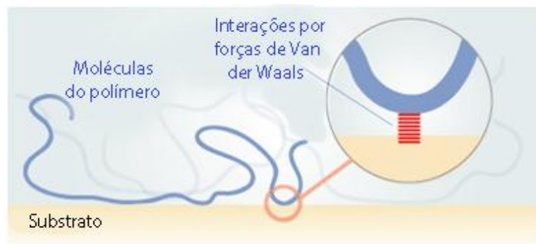
Figura 2.18 - Figura esquemática representando o processo de adesão por meio de forças de Van der Waals entre as cadeias do polímero sobre-injetado e o substrato ou inserto (Adaptado de PACKHAM, 2005).
