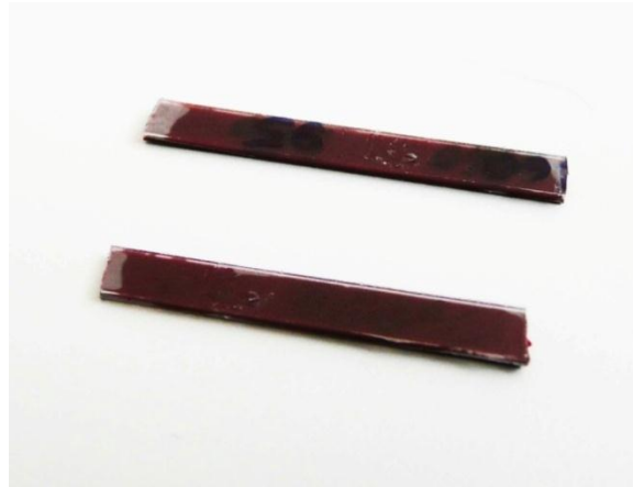
Figura 4.38 - Corpos de prova submetidos a ensaio de tensão versus deformação em DMA (temperatura de processamento 260 °C).
