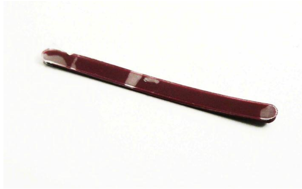
Figura 4.45 - Corpos de prova submetidos a ensaio de fadiga em equipamento de DMA (temperatura de processamento de 240 °C, amplitude do deslocamento 1mm e frequência do ensaio de 10Hz).
