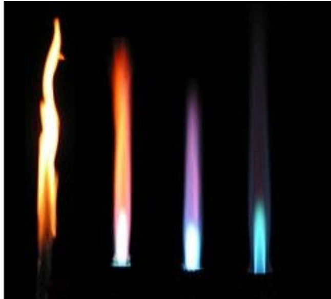
Figura 1.1 – Chamas em queimadores planos. As diversas chamas são para diferentes relações mássicas entre combustível e comburente.
