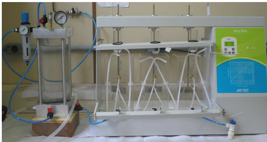
Figura 12: Equipamento floteste utilizado nos ensaios de flotação por ar dissolvido.
