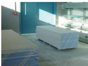
Figura 3.1 - a) armazenamento de CGA standard e b) Tipos de CGA. Fonte: Placo (2009)
