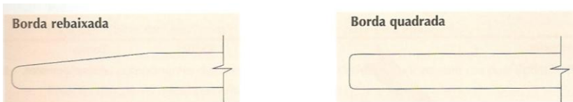
Figura 3.2 – a) CGA com borda rebaixada e b) CGA com borda quadrada. Fonte: Drywall (2004).
