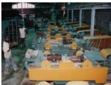
Figura 3.6 - a) Equipamento para a produção de lâ de madeira e b) produção de lâ de madeira com máquina de duas facas. Fonte: Eltomation (2006)
