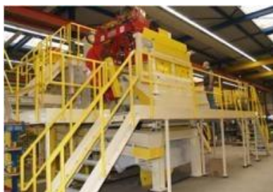
Figura 3.6 - a) Equipamento para a produção de lâ de madeira e b) produção de lâ de madeira com máquina de duas facas. Fonte: Eltomation (2006)
