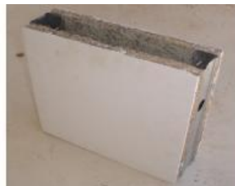
Figura 3.8 – a) algumas variações de PCMM e b) amostra de painel de vedação com PCMM e perfis metálicos.
