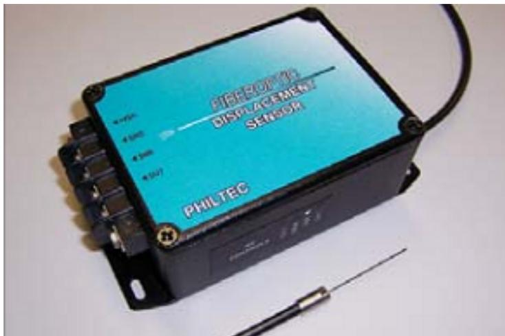
Figura 3.16: Transdutor de fibra óptica utilizado.
