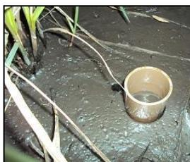
Figura 21: Amostrador para coleta de lodo
