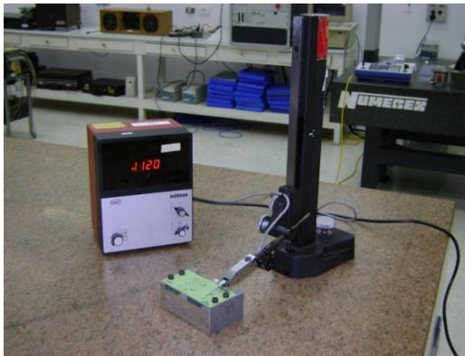
**Figura 3. 11:** Montagem do sistema de medição para avaliação da altura de rebarbas
