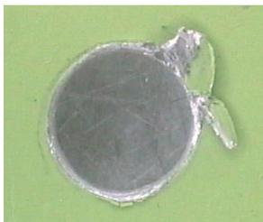
**Figura 4. 27:** Formação da rebarba na saída da chapa superior acumulada em uma região do furo
