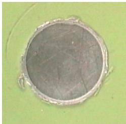
**Figura 4. 28:** Formação da rebarba na entrada da chapa inferior
