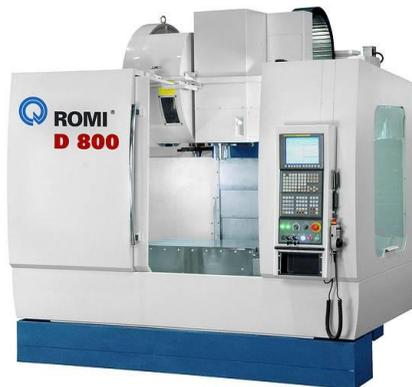
**Figura 3.7:** Centro de usinagem vertical Romi D800
