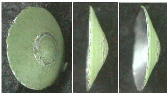
**Figura 4.32:** Rebarba tipo “chapéu” totalmente destacada feita com a broca EMB
