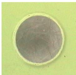
**Figura 4. 26:** Formação da rebarba na entrada da chapa superior
