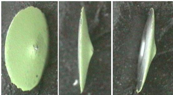
**Figura 4. 29:** Rebarba tipo “chapéu” feita com a broca de ponta de centragem com  $d_p$  positiva
