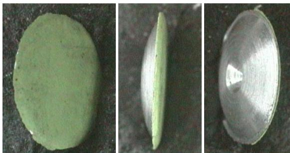
**Figura 4. 30:** Rebarba tipo “chapéu” feita com a broca de ponta de centragem com  $d_p$  nula
