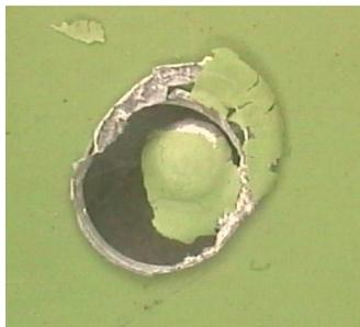
**Figura 4.31:** Rebarba tipo “chapéu” aderida à saída do furo feita com a broca EMB
