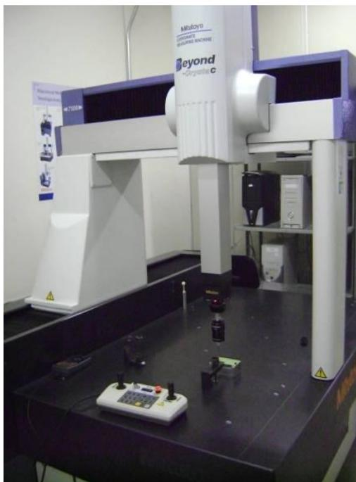
**Figura 3. 12:** Máquina de medir por coordenadas Mitutoyo Crysta C 7106
