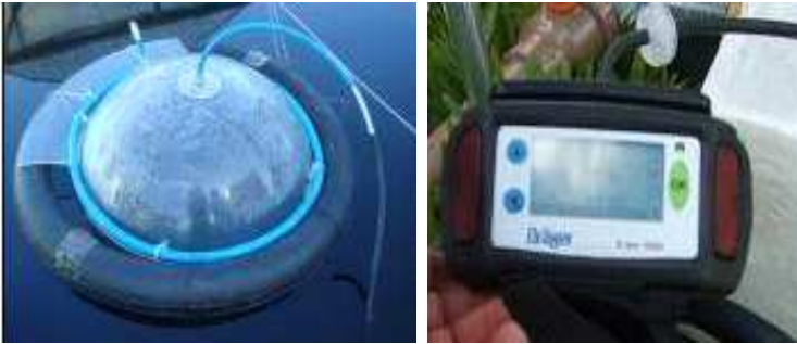
Figura 8- Câmara de fluxo de acrílico colocada sobre a lagoa, com mangueira de sucção de ar (direita) e equipamento de medição Dräger (esquerda)
