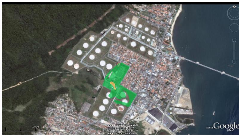
Figura 4: Risco Simulado: CETESB, Industrial, Adulto, Água Subterrânea, Contato Dérmico com Água Subterrânea Contaminada, Benzeno
