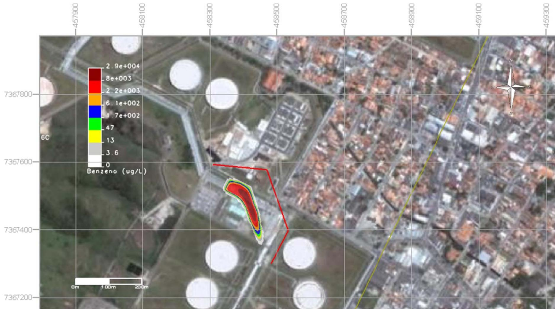
Figura 4.16 – Pluma de contaminação de benzeno contida pela barreira física 30 anos após o vazamento. Extensão da pluma de, aproximadamente, 180m.
