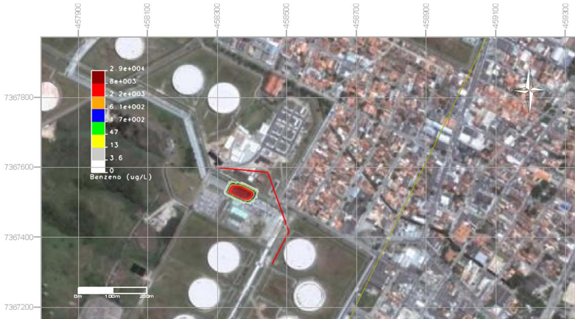
Figura 4.15 - Pluma de contaminação de benzeno no instante de instalação da barreira física, 24<sup>o</sup> mês após o vazamento. Extensão da pluma de, aproximadamente, 90m.
