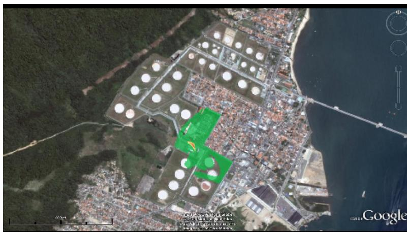
Figura 2: Risco Simulado NC: CETESB, Industrial, Adulto, Água Subterrânea, Contato Dérmico com Água Subterrânea Contaminada, Benzeno
