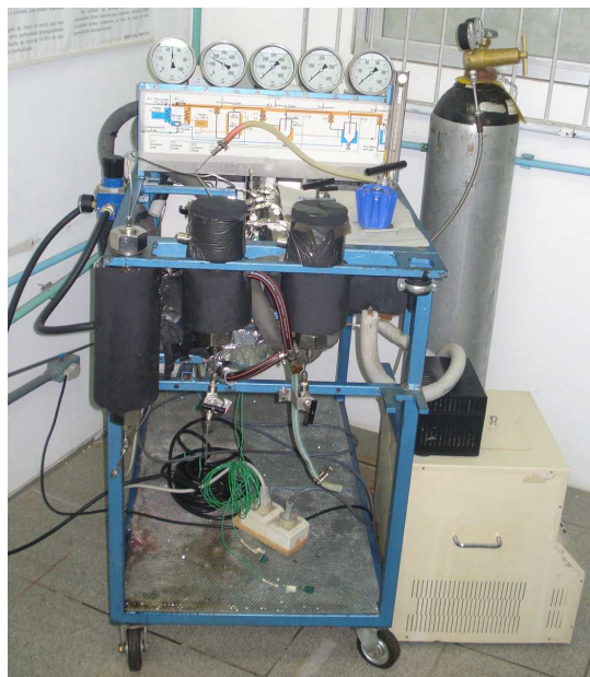
Figura 14. Imagem da unidade de extração do Laboratório de Termodinâmica e Extração Supercrítica (LATESC) da UFSC
