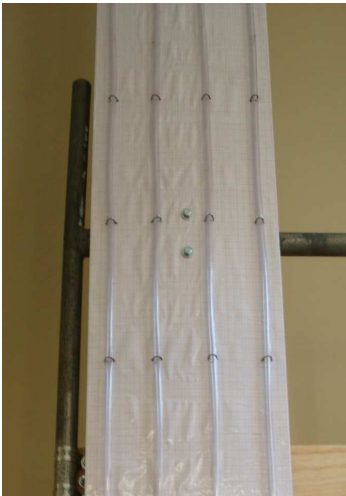
Figura 24: Foto da leitura piezométrica do sistema em colunas de sedimentos.
