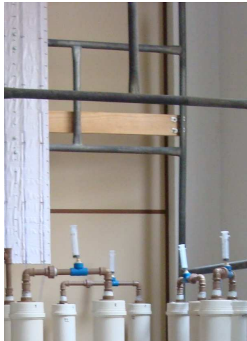
Figura 25: Foto do ponto de coleta por meio de seringas.
