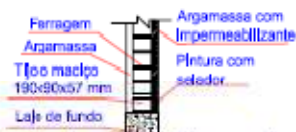
Detalhe 9b - Alvenaria armada (detalhe transversal)
