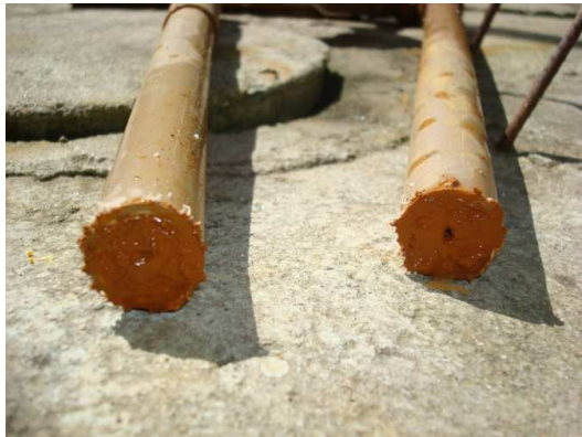
Figura 40: Foto do tubo de sucção com seção transversal obstruída.
