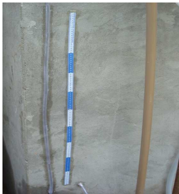
C – Foto do piezômetro construído de mangueira com acompanhamento de carga em fita métrica.
