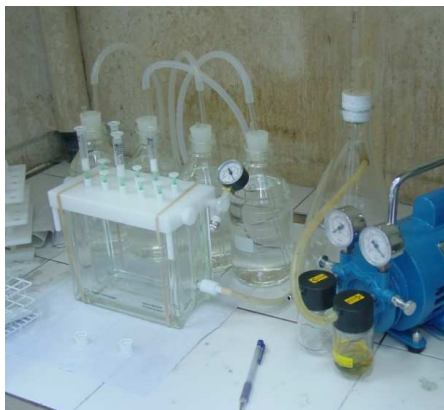
Figura 29: Foto do manifold conectado à bomba de vácuo para extração do carbofurano.
