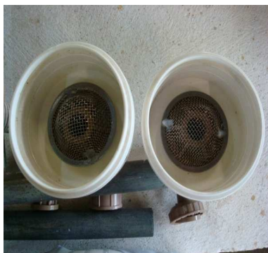
Figura 26: Foto da grade suporte do solo/subsolo.
