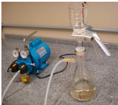
Figura 28: Foto do sistema de filtração das amostras.
