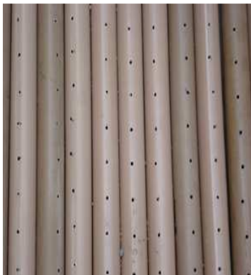
D – Foto dos tubos distribuidores de água.
