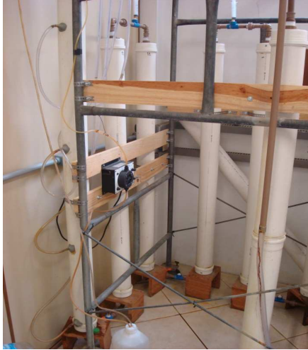
Figura 23: Foto dos piezômetros localizados na primeira coluna do sistema.
