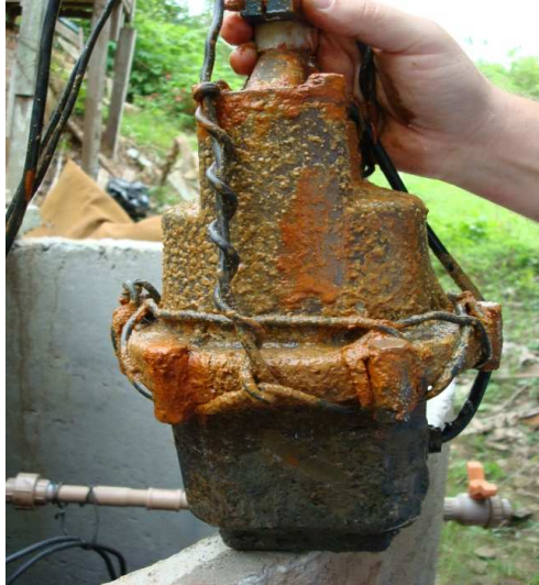
Figura 39: Foto da bomba submersa obstruída com ferro.
