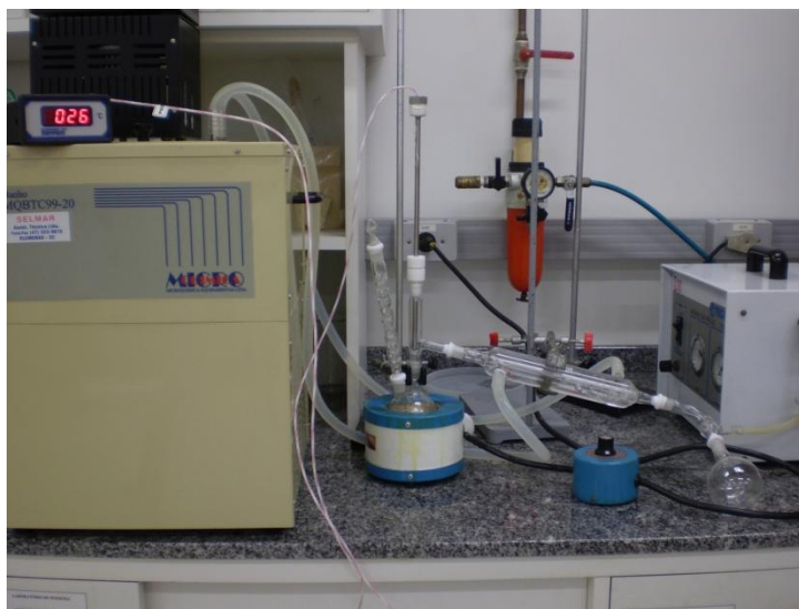
Figura 14: Destilação da amostra resultante da reação de transesterificação.
