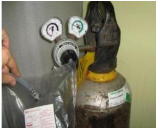
Figura 37: Utilização de do cilindro de CO 2 no preenchimento de um saco Tedlar®
