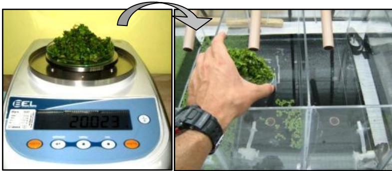
Figura 39: Pesagem inicial e inoculação das lemnas nos Reatores Fotossintéticos (RF)
