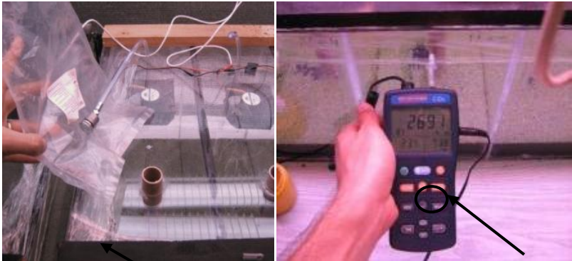
Figura 40: Introdução do CO 2 no Reator Fotossintético, através de um saco Tedlar® (esquerda); Medição de CO 2 com o sensor Instrulterm (direita). Destaque para as mangueiras de conexão.
