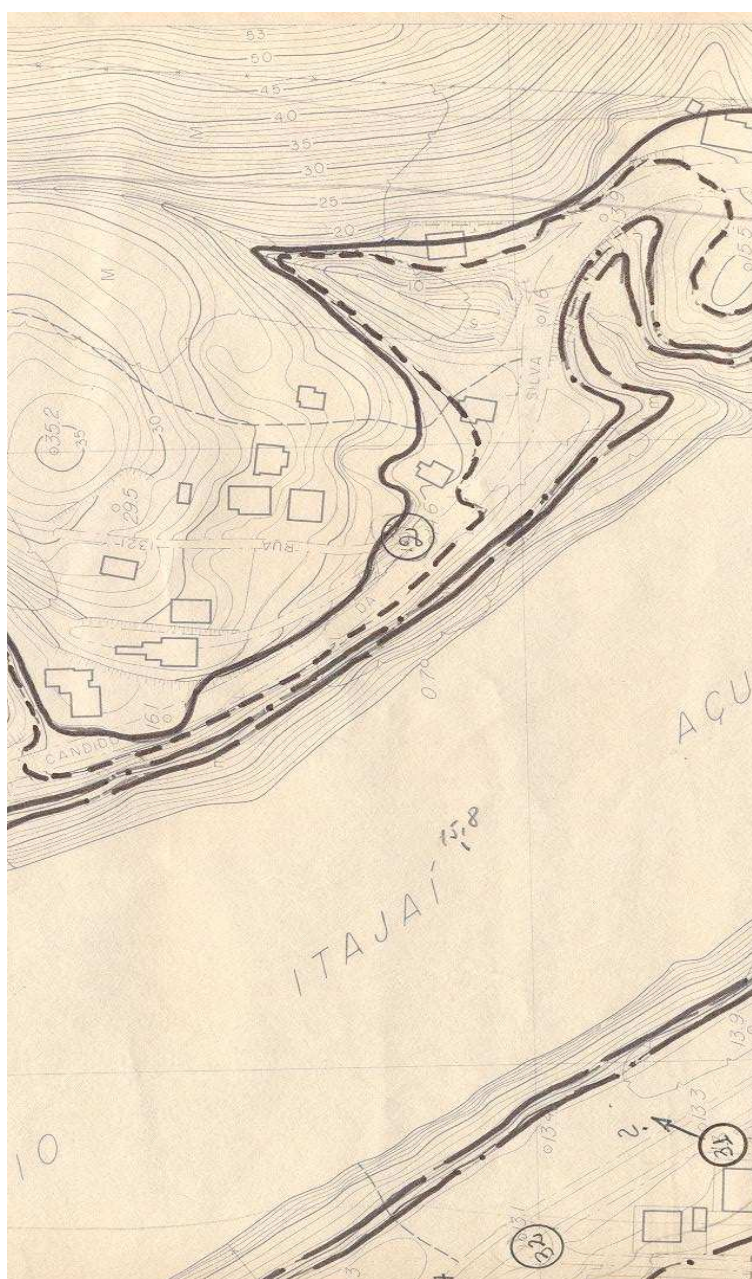
Figura 5.4 – Extrato parcial do traçado das manchas de inundação para os níveis de 10,00, 12,00, 15,46 e 17,00 metros em Blumenau
