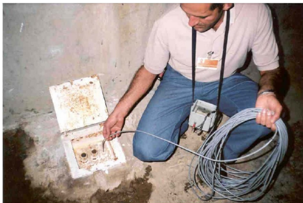
Figura 5: Técnico efetuando a medição de nível piezométrico
