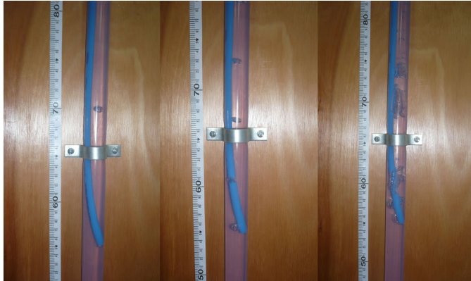
Figura 25: Representação dos tipos de borbulhamento obtidos. Borbulhamento suave (à esquerda), borbulhamento médio (ao centro) e borbulhamento violento (à direita)
