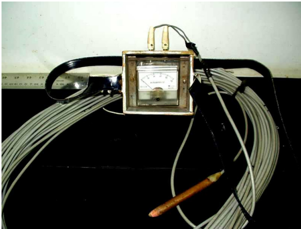
Figura 3: Equipamento utilizado para leitura do nível piezométrico
