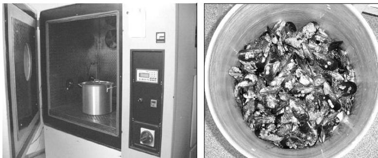
**Figura 19** - Câmara de vácuo e o recipiente com mexilhões para a técnica de resfriamento a vácuo
