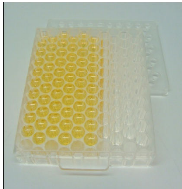
Figura 3.1. Exemplo de placa do Bioscreen C usada na realização dos experimentos, onde os poços são preenchidos com diferentes meios MRS.
