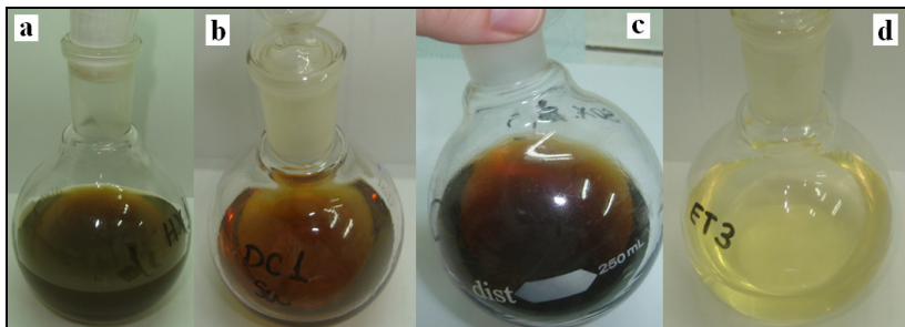
Figura 23. Mistura solvente + extrato obtida na extração Soxhlet: (a) hexano; (b) diclorometano; (c) acetato de etila; (d) etanol.
