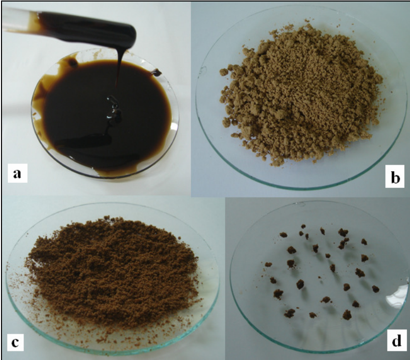
Figura 11. Etapas do pré-tratamento da matéria-prima. (a) matéria-prima; (b) precipitado úmido, obtido após etapa de filtração a vácuo; (c) matriz das extrações: material obtido após secagem e moagem do precipitado úmido; (d) partículas grossas descartadas na seleção visual.
