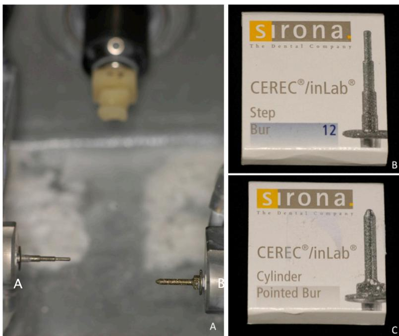
Figura 23 – Bloco e as pontas diamantadas posicionados na unidade fresadora Cerec Scan (A). Em detalhe, os desenhos das duas pontas (B e C).
