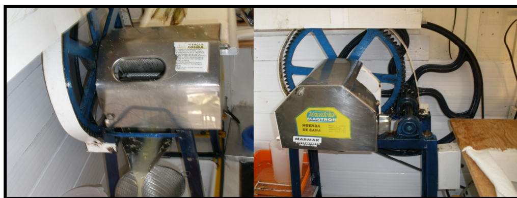
Figura 5. Moenda de aço inoxidável utilizada para o esmagamento da cana. (Acervo do autor)
