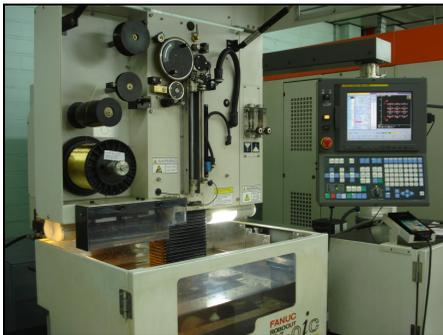
(d) eletroerosão a fio marca Fanuc Robocut α-01 CB.
