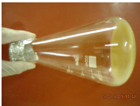
Figura 2.4 Filtrado contendo 1,2-carbonato de propileno + P(3HB).
