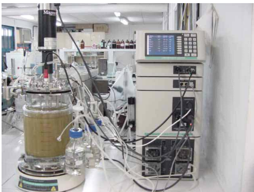
Figura 2.1 Biorreator Bioflo 110 utilizados nos experimentos.
