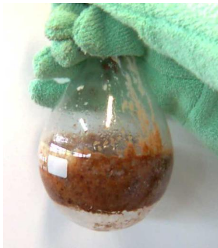
Figura 3.4 P(3HB) e resíduos celulares aderidos à parede do balão volumétrico, após o processo de extração com 1,2-carbonato de propileno, utilizando-se células úmidas.
