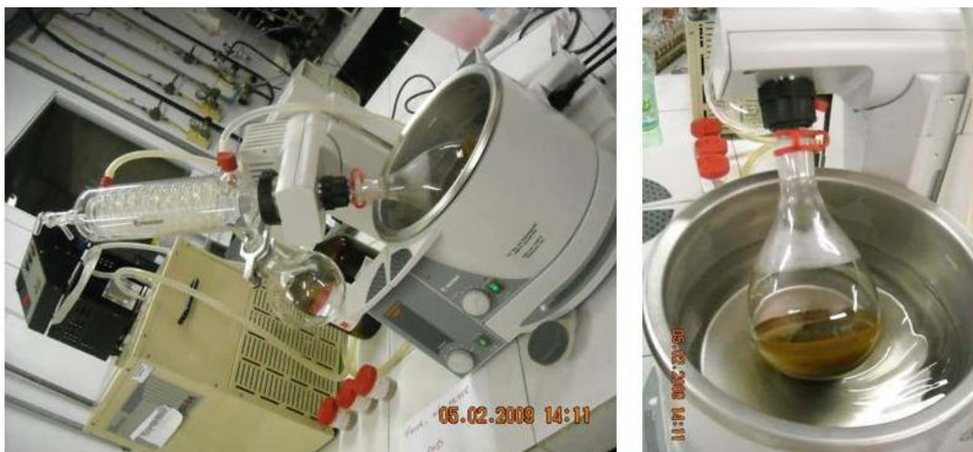
Figura 2.3 Equipamento (rotaevaporador) utilizado para os testes com o solvente 1,2-carbonato de propileno para a extração de P(3HB).
