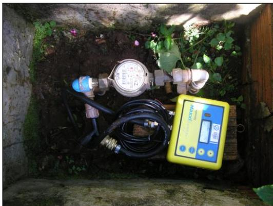
Figura 13. Medidor contínuo de pressão.
