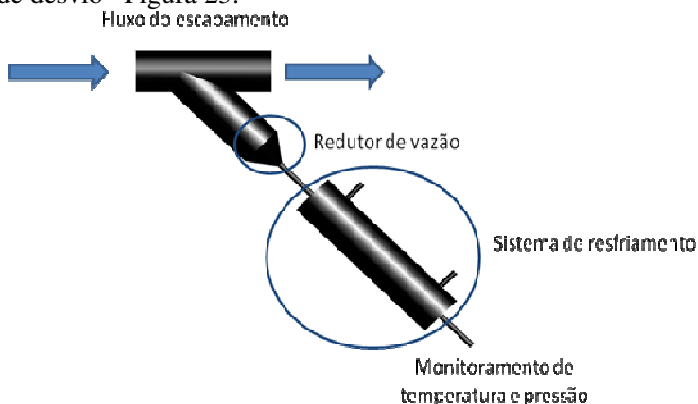
Figura 23. Esquema da concepção inicial para coleta de gases do escapamento.
