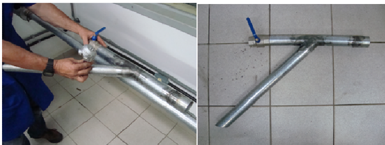
Figura 24. Esquema de uma concepção inicial para coleta de gases do escapamento.
