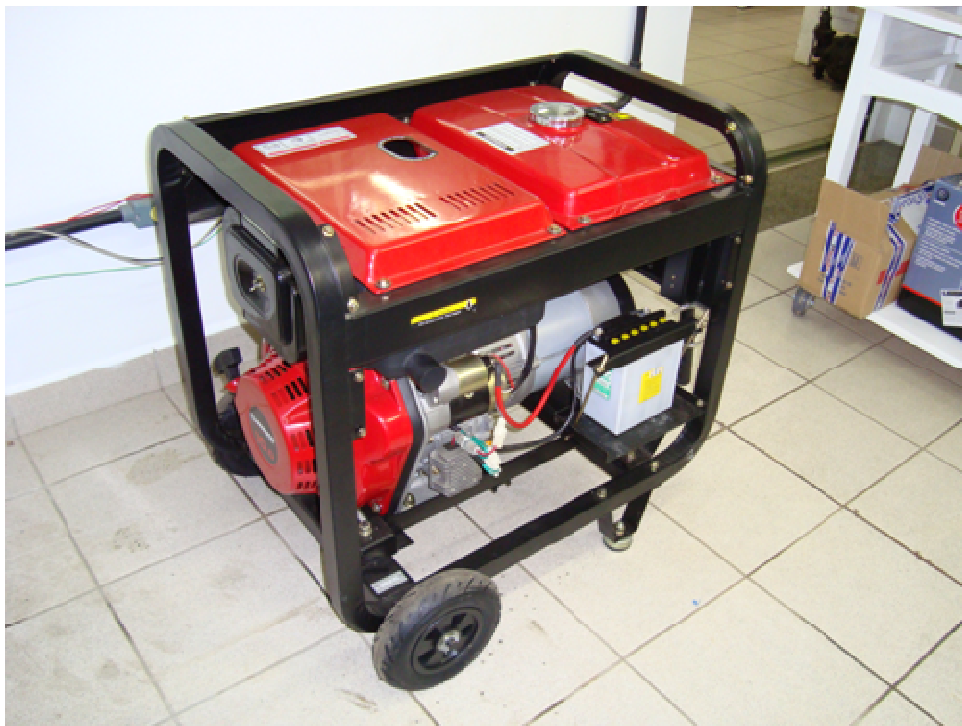
Figura 19. Motogerador selecionado para os ensaios de emissão.
