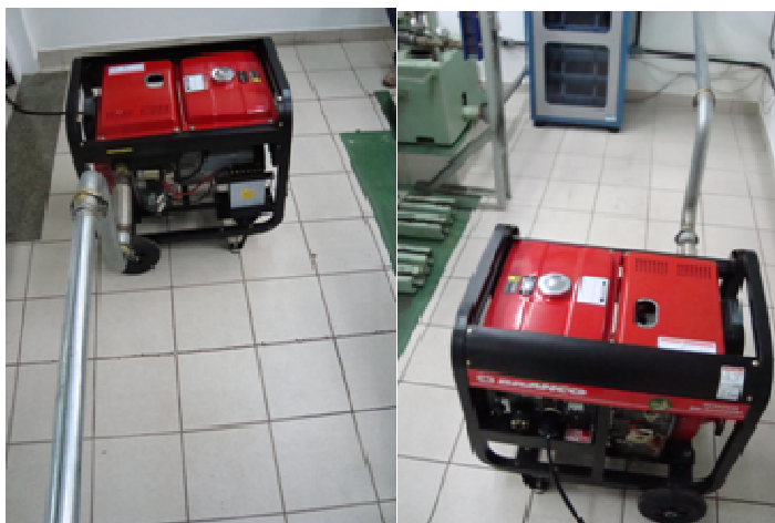
Figura 22. Prolongamento do escapamento para garantir um fluxo laminar.
