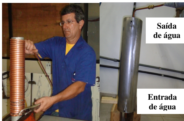
Figura 25. Confecção da serpentina de cobre do trocador de calor.
