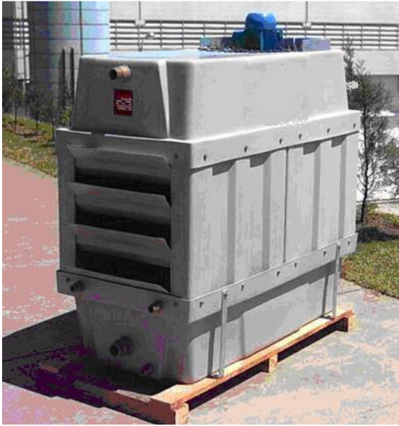
Figura 6 – Foto da torre de resfriamento adaptada ao experimento
