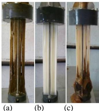
**Figura 60: Aspecto visual do módulo de membranas (a) após 30 dias de operação; (b) após a realização de limpeza química e (c) após 154 dias de operação.**
