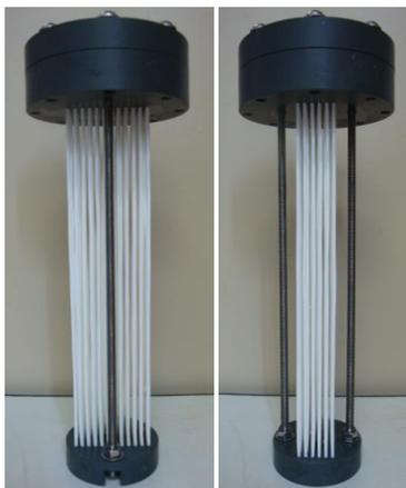
**Figura 27: Módulo de membranas utilizado (Imagem frontal e lateral).**
