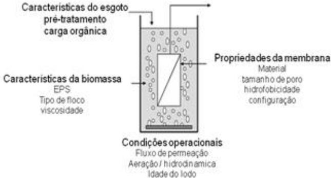
**Figura 20: Fatores que influenciam no *fouling* em biorreatores à membrana (LE-CLECH *et al.*, 2006).**
