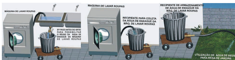
Figura 11 - Esquema de utilização da água da máquina de lavar para irrigação de jardim.
