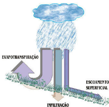
Figura 12 - Esquema da retenção da água na cobertura
