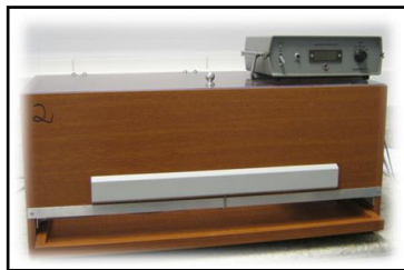
Figura 3: Ilustração do teste da caixa de atividade. Fonte: LEXDON-UFSC.
