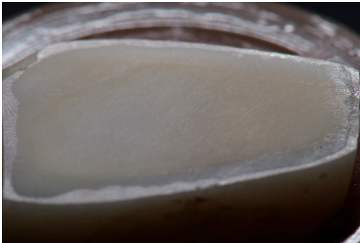
Figura 20 - Espécime do grupo SBP-I, após aplicação da escova robson com pasta de pedra pomes e água. Assim como na fotografia anterior o padrão uniforme da superfície e a ausência de brilho demonstram o poder abrasivo da pedra pomes.
