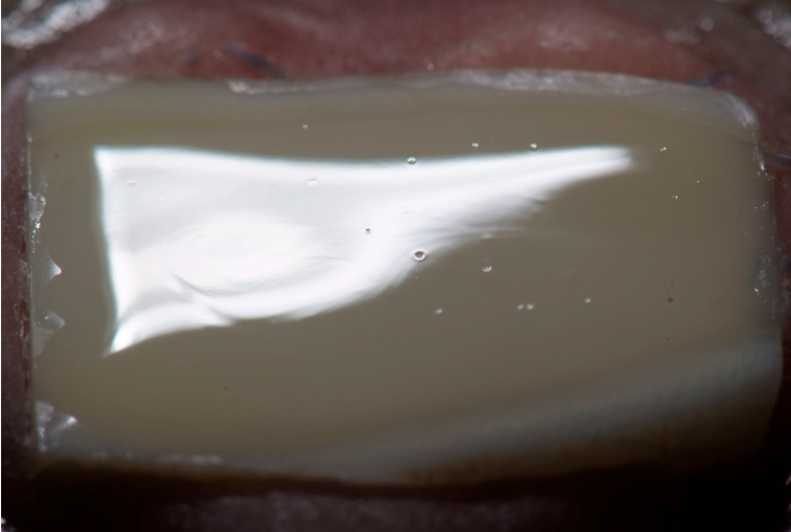
Figura 28 - Espécime do grupo HF-I, após aplicação e polimerização de uma fina camada de resina flow. Conseguindo uma uniformidade ao longo de toda a superfície do espécime.
