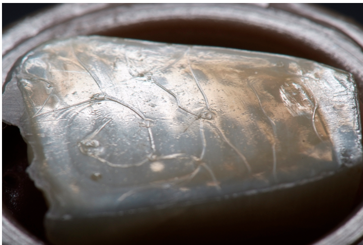
Figura 18 - Fotografia da superfície do espécime do grupo SEG-I, apresentando uma diminuição no brilho superficial além da formação de grandes vincos superficiais.
