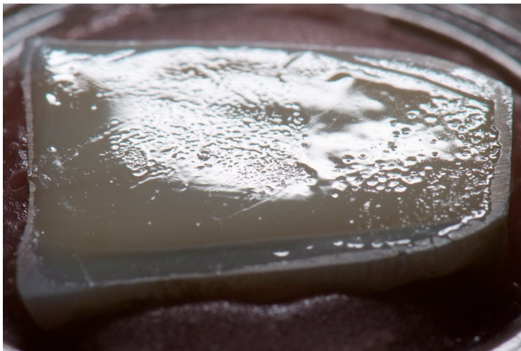
Figura 17 - Fotografia da superfície do espécime do grupo SBG-I, apresentando uma superfície bem irregular (arenosa).
