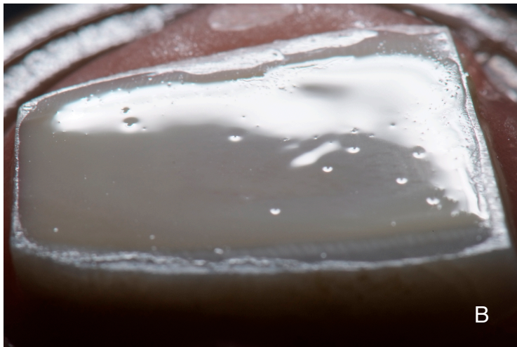
Figura 14 - Fotografia da superfície do espécime do grupo SBH-I, apresentando uma camada lisa e uniforme mas com a freqüente presença com bolhas de ar na superfície.
