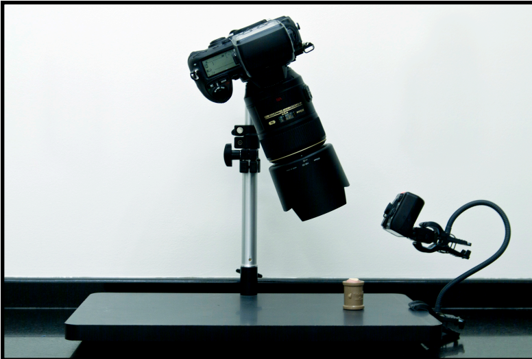
Figura 10 - Imagem da câmera fotográfica montada na estativa. A câmera foi inclinada e o flash posicionado lateralmente para que pudéssemos obter uma imagem da superfície do espécime.
