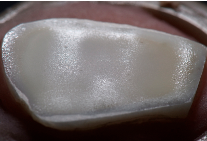
Figura 22 - Espécime do grupo FLB-I, após aplicação do jato de bicarbonato de sódio, demonstrando a falta de padronização conseguida na superfície, com a aparência arenosa nas áreas de maior brilho.
