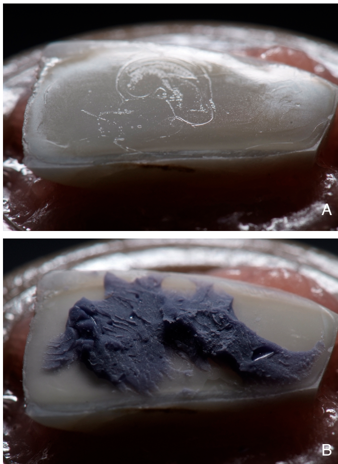
Figura 31 - Fotografia de um espécime do grupo FLG-I evidenciando a interação entre o sistema adesivo e o material de moldagem. A - antes da moldagem, B - após a moldagem. Observe a ruptura do material de moldagem (Impregum Soft) durante a sua remoção, permanecendo aderido à superfície hibridizada. Esse padrão foi observado também nos grupos FLP-I, FLB-I, FLA-I, SBH-I, SBC-I, SBP-I, SBB-I, SBA-I e SEG-I.
