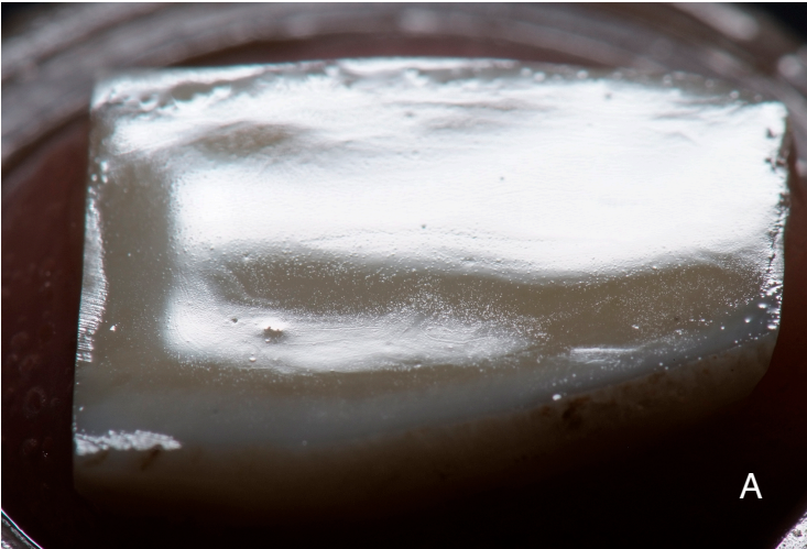
Figura 13 - Fotografia da superfície do espécime do grupo FLH-I, apresentando uma camada lisa e uniforme.
