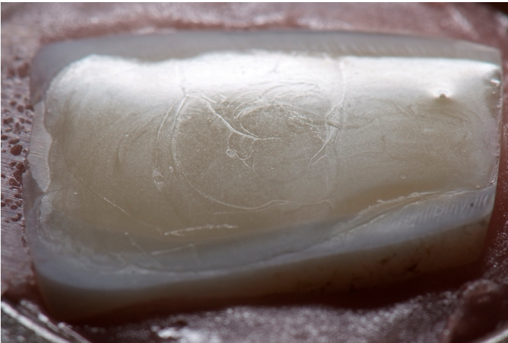
Figura 16 - Fotografia da superfície do espécime do grupo FLC-I, apresentando uma diminuição efetiva no brilho superficial além da formação de pequenas irregularidades superficiais.
