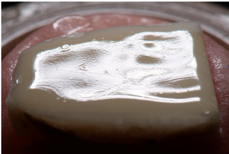
Figura 29 - Fotografia de espécime do grupo HFG-I, mostrando a manutenção da lisura e leve diminuição no brilho superficial após a polimerização através do gel KY, além da formação de pequenos vincos na superfície.
