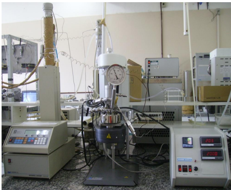
Figura 4.3. Vista geral da unidade de reação. Da esquerda para a direita: a bomba seringa, o reator encaixado na manta de aquecimento e o controlador do reator.
