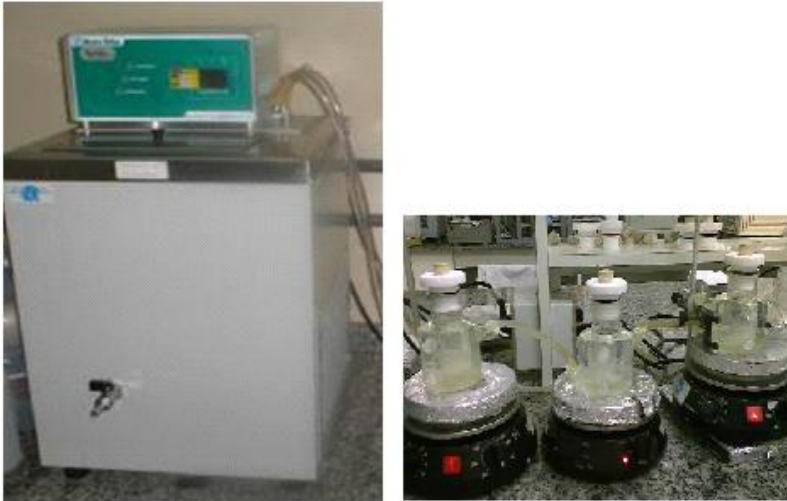
Figura 4.4. Sistema composto de um banho termostático e reatores de vidro utilizados para a determinação da atividade enzimática.
